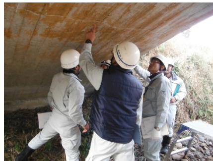
RCアーチ橋を近接目視や打音検査の実習しました
