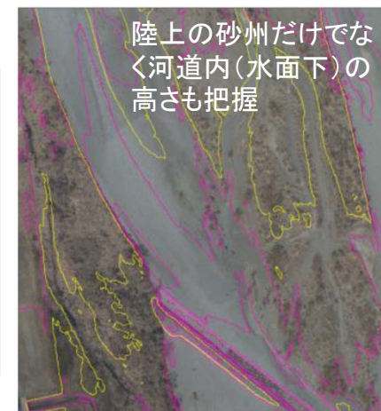
図 ALBによる河床高コンター図
