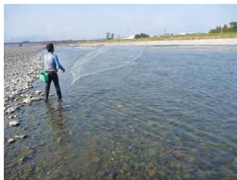
図 調査実施状況(投網による採捕)
