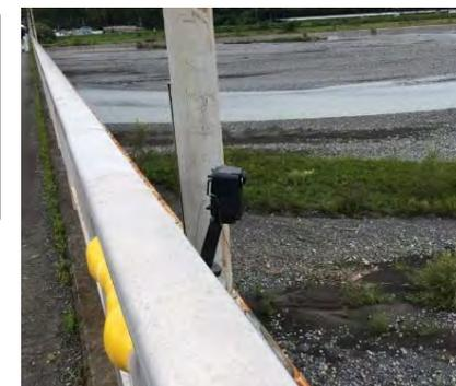
図 タイムラプスカメラによる観測状況（安倍川）
