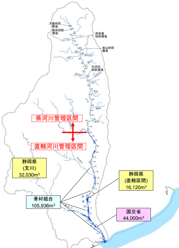
砂利採取・河道掘削位置(R6年度実績)
