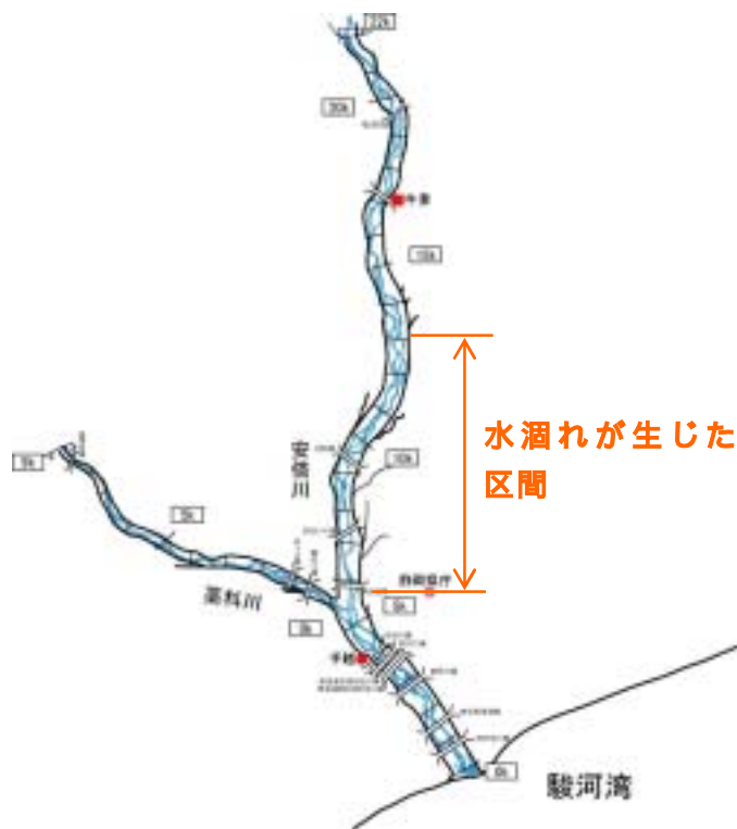
図-2.1.21 水涸れ発生区間(平成 17 年 12 月)
