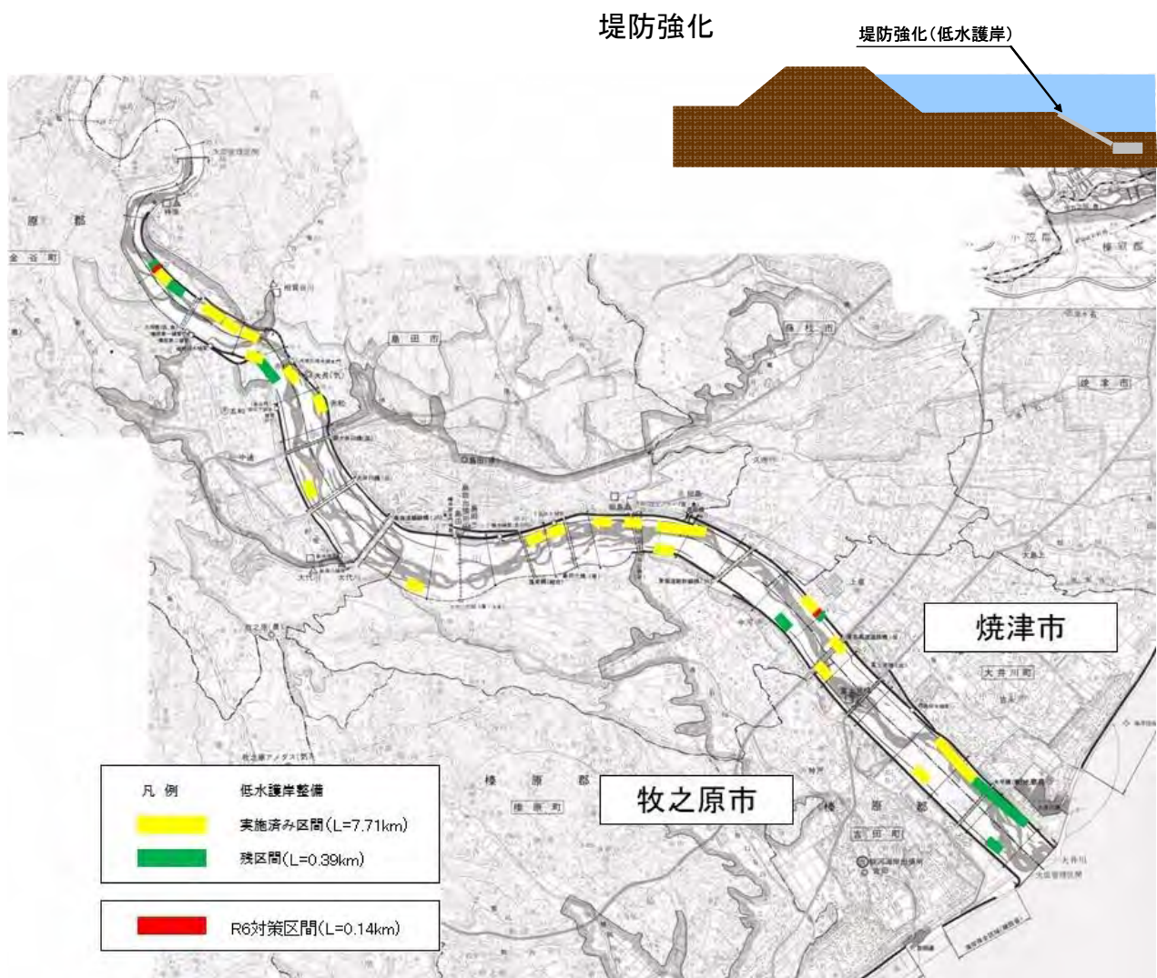
図-23 堤防強化対策実施状況
