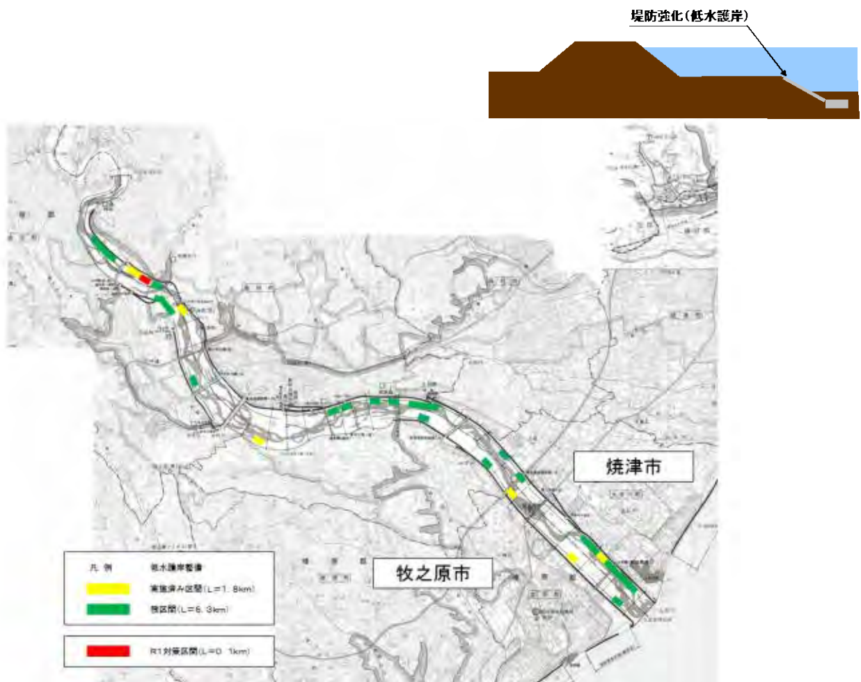
図-23 堤防強化対策実施状況
