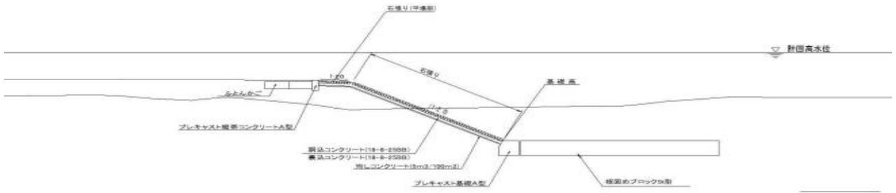
図-27 高水敷整備断面図
