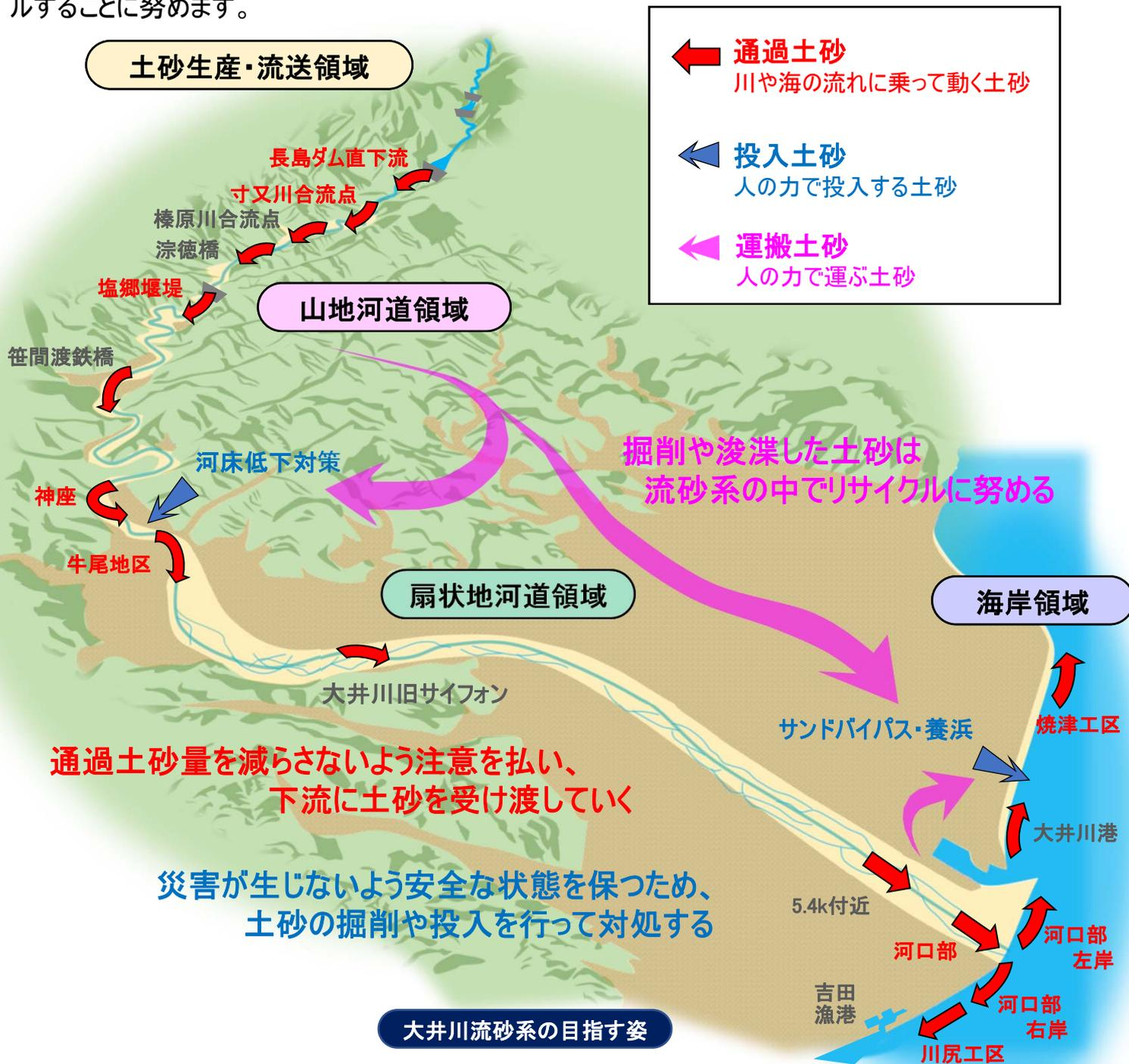
第二版の計画では、長島ダムより上流の範囲を含めて、土砂還元(ダムに堆積した土砂を掘削して、川に流す対策)や、土砂流送しやすい河道整備(川のかたちを工夫してスムーズに流れるようにする対策)を進め、通過土砂量を今よりもっと増やし、土砂が連続して動く健全な流砂系の姿を目指して取組みを進めていきます。
