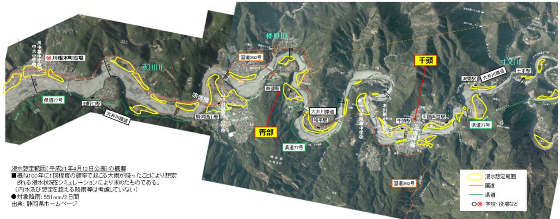
図 3-6 流下能力不足区間の浸水想定範囲（川根長尾川合流点～寸又川合流点付近）
