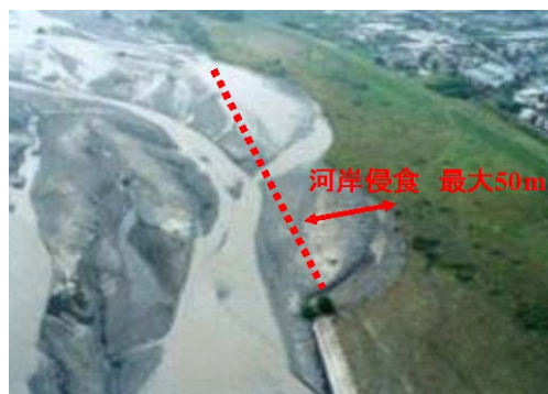
図 6-10 平成 12 年 9 月洪水における河岸侵食状況（安倍川左岸 11.75k 付近）
