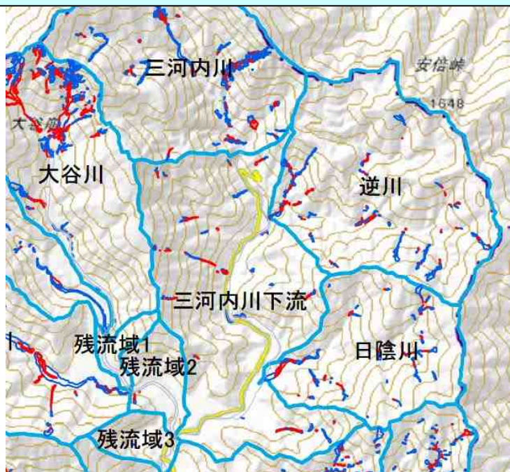
崩壊地判読結果(赤:堆積箇所、青:洗掘箇所)
