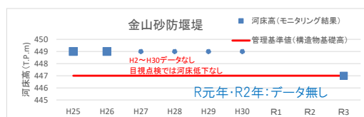
洪水物直下の河床低下確認例
