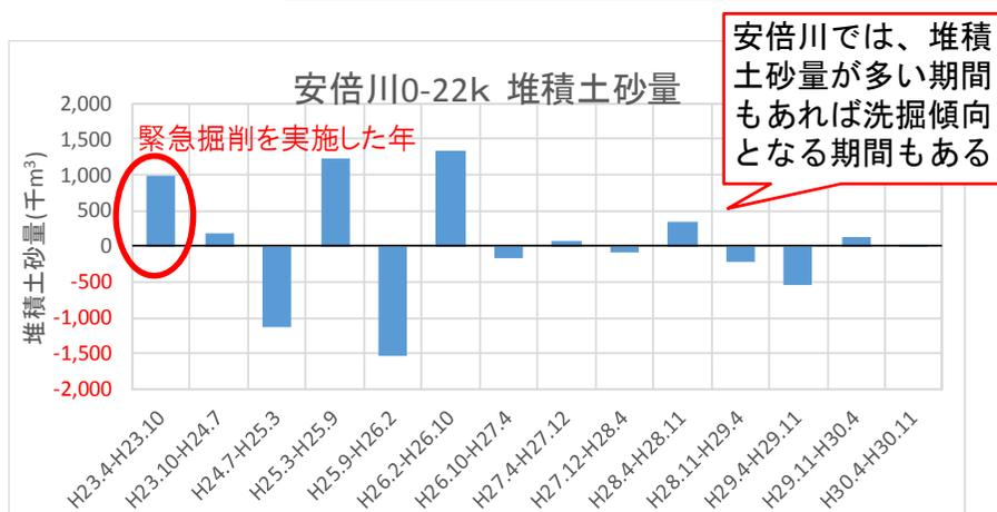
図 LP測量より算定した安倍川の堆積土砂量の推移
