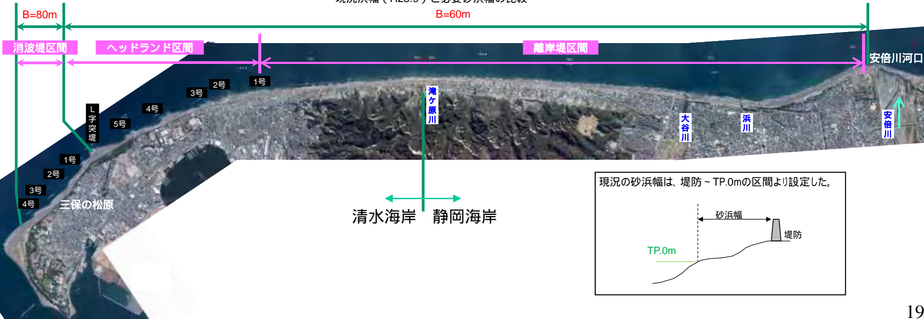
現況浜幅 (H25.9) と必要砂浜幅の比較
