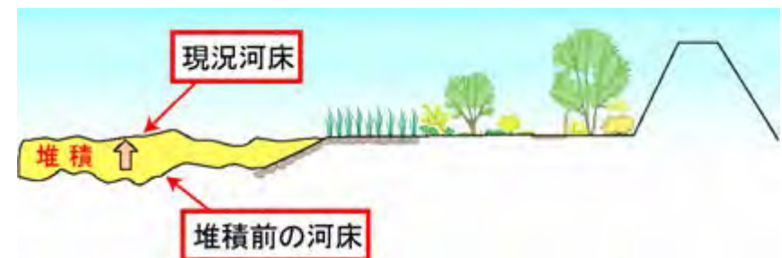
河床上昇による低水路の埋塞（右写真：左岸5k付近の状況・平成19年）
