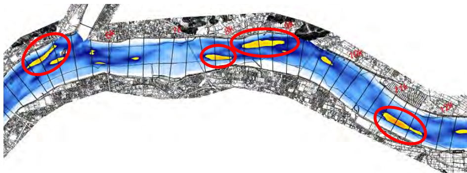
局所洗掘個所の確認
