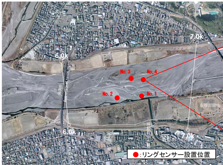
リング式センサー設置位置図
