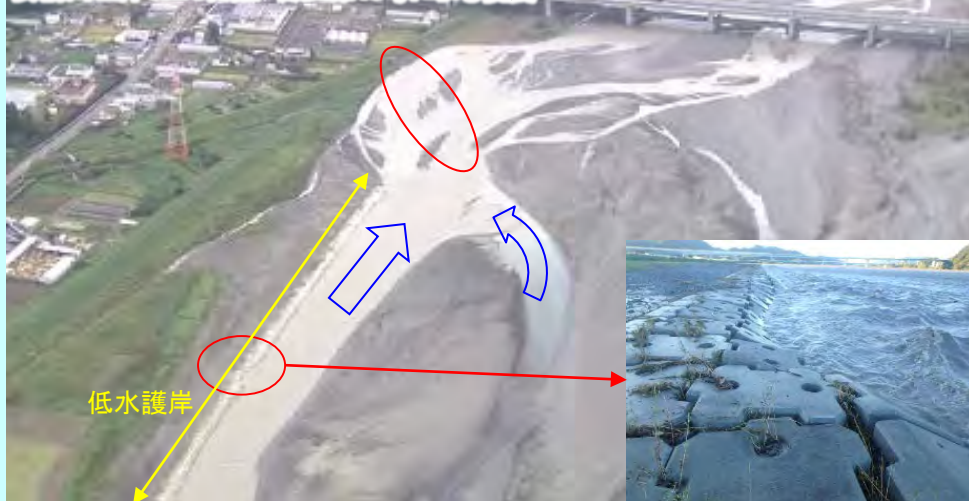
安倍川左岸13.75付近 台風第19号による侵食
