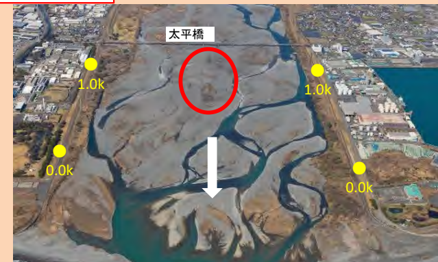
飯淵・川尻地区 河道掘削 V=26千m 3
