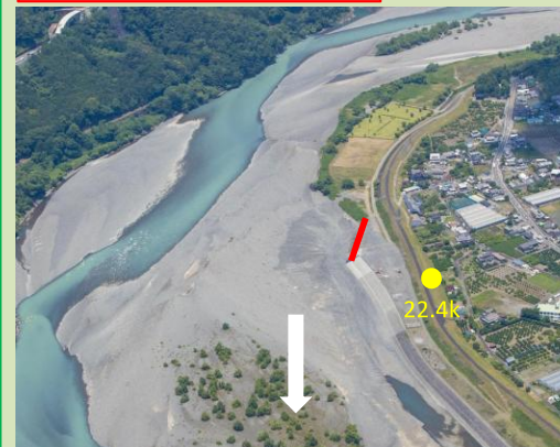
飯淵・川尻地区 河道掘削 V=30千m 3
