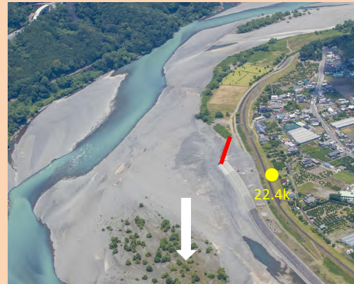
飯淵・川尻地区 河道掘削 V=26千m 3
