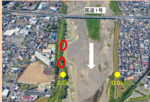
下川原地区 河道掘削V=30千m³
