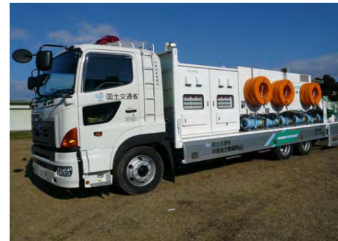
排水ポンプ車
