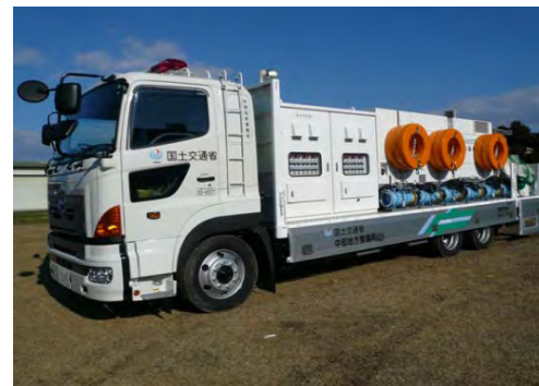
排水ポンプ車
