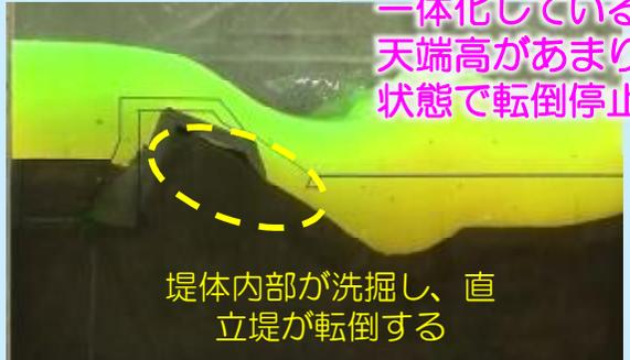
堤体内部が洗掘し、直立堤が転倒する
