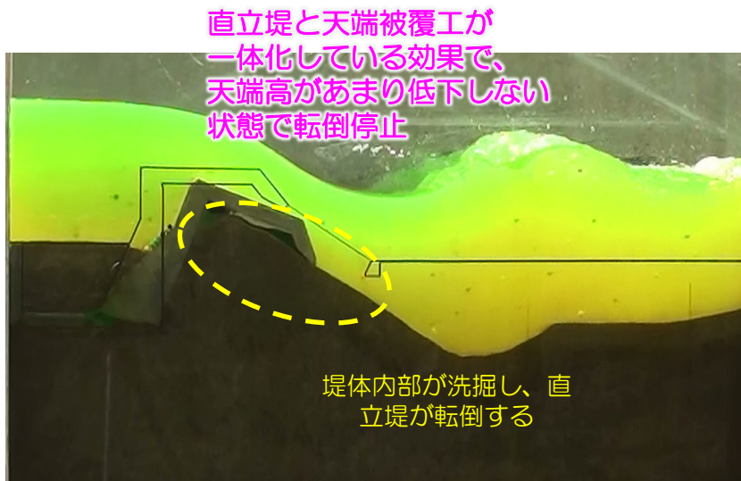
対策案に対する越流実験結果（転倒停止時）
