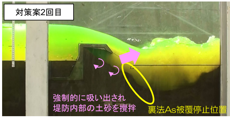
堤防内に土砂はある程度残置しているが、攪拌され支持力を失っている可能性がある
