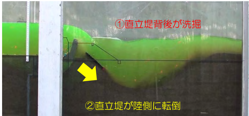
A区間-3の被災メカニズム
