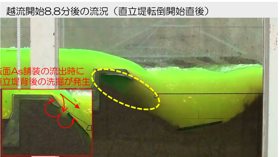
越流開始8.8分後における堤防及び背後地の洗掘状況
