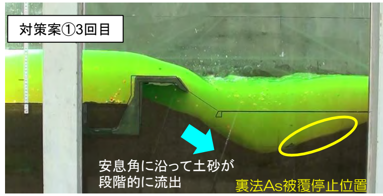
直立堤転倒開始時の裏法As被覆の飛散状況
