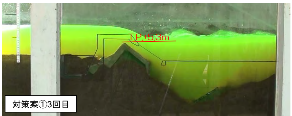
直立堤転倒停止時の直立堤天端高の比較 (A区間-3対策案①)
