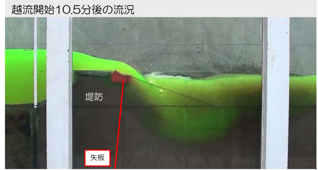
越流開始10.5分後における堤防及び背後地の洗掘状況
