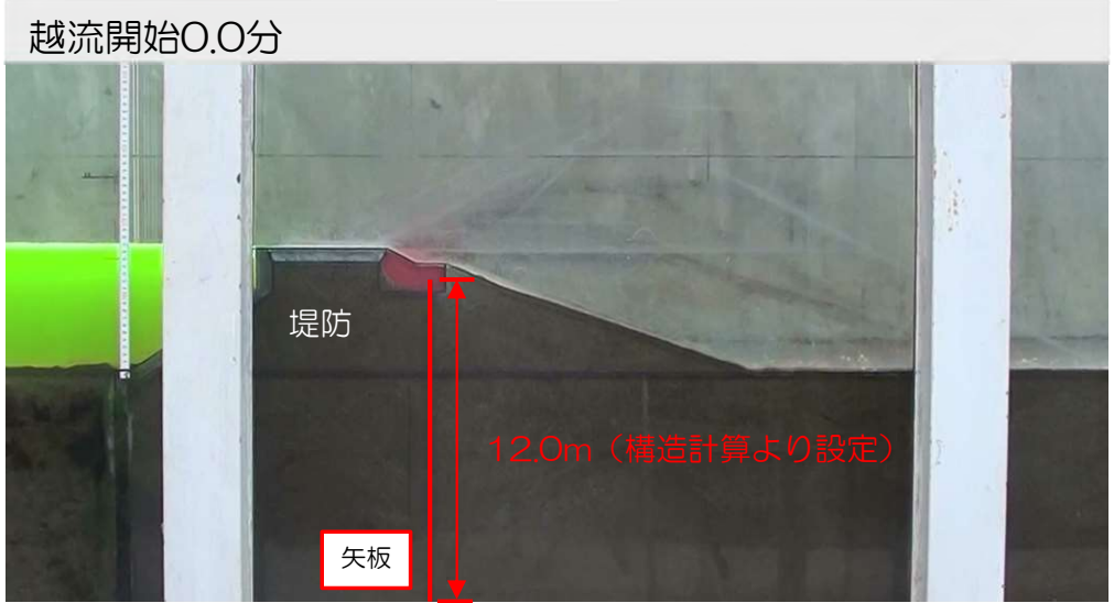
越流前の流況
