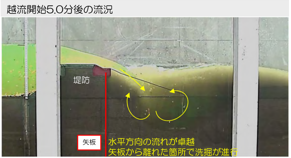
越流開始5.0分後における堤防及び背後地の洗掘状況
