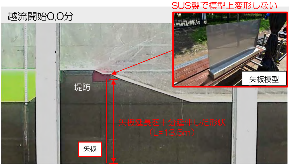
越流前の流況
