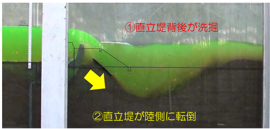
A区間-3の被災メカニズム
