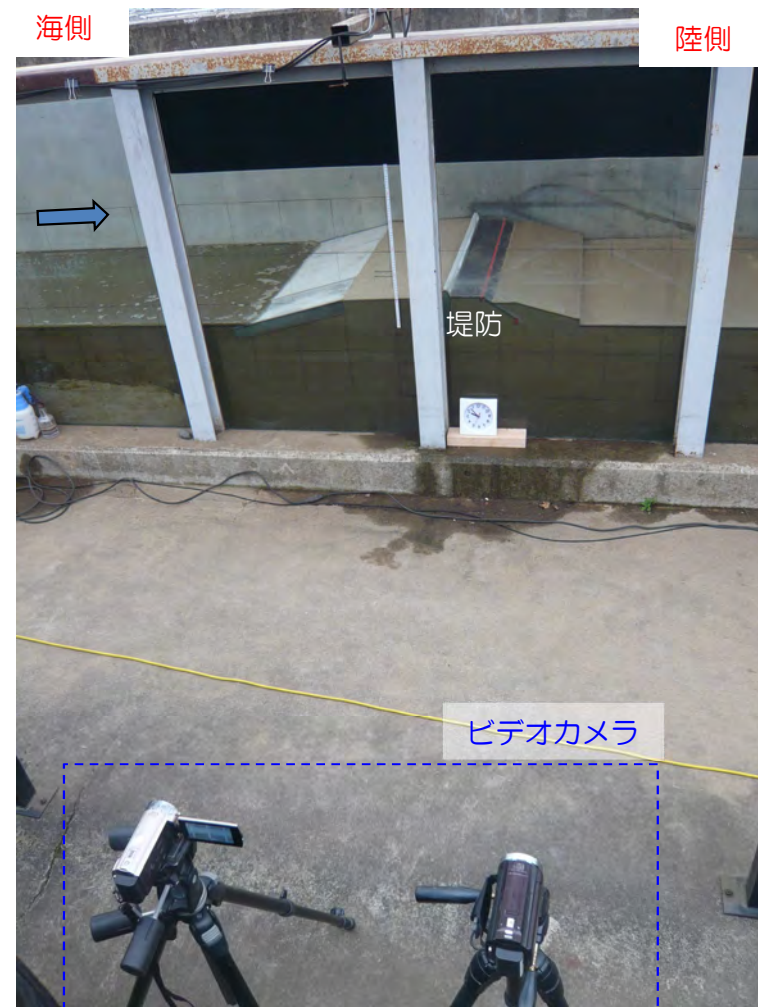
ビデオカメラの設置状況
