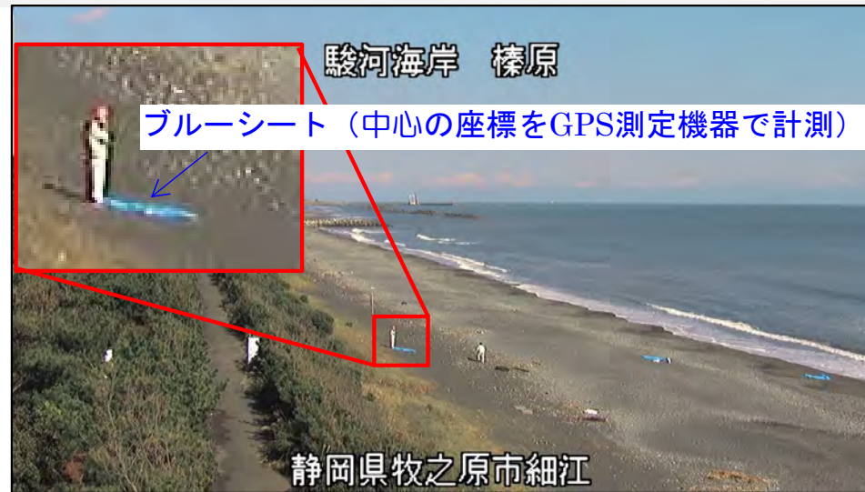
図 座標計測の例
