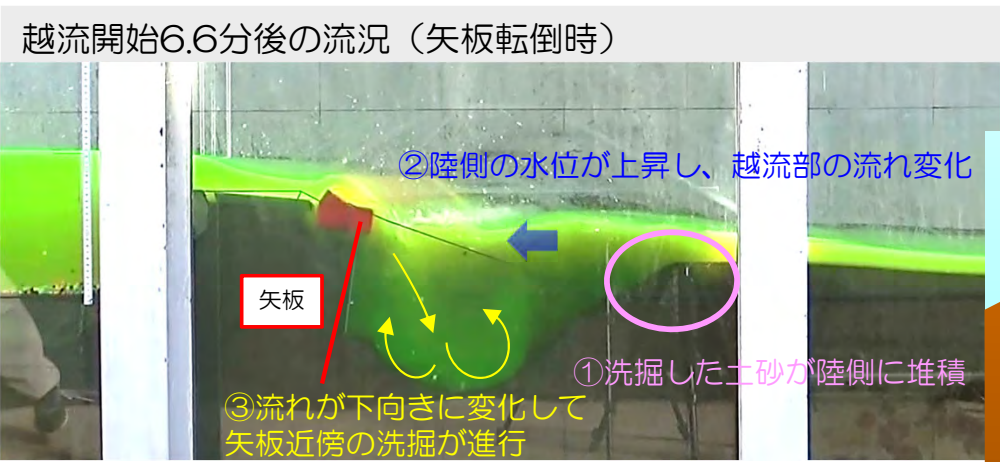
越流開始6.6分後における堤防及び背後地の洗掘状況 (R2年度)
