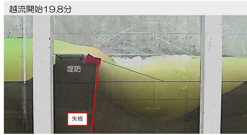
越流開始19.8分後における堤防及び背後地の洗掘状況
