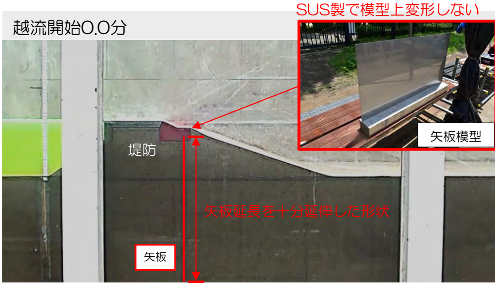
越流前の流況
