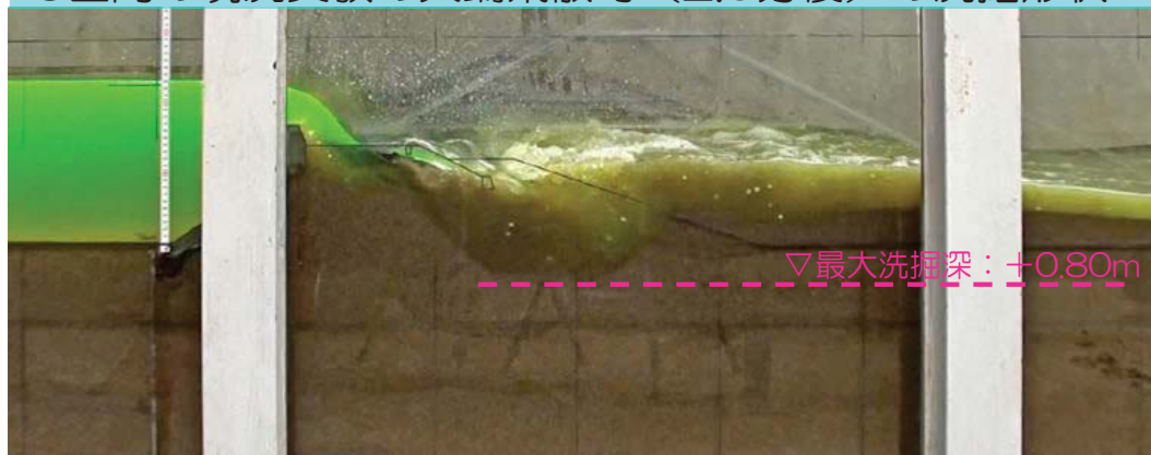
C区間の現況実験の天端飛散時（2.0分後）の洗掘形状
