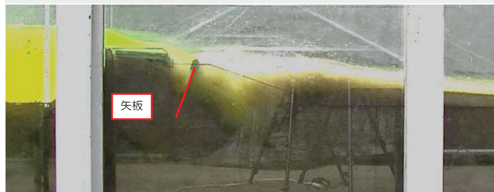
越流開始2.5分後の流況（矢板転倒時）
