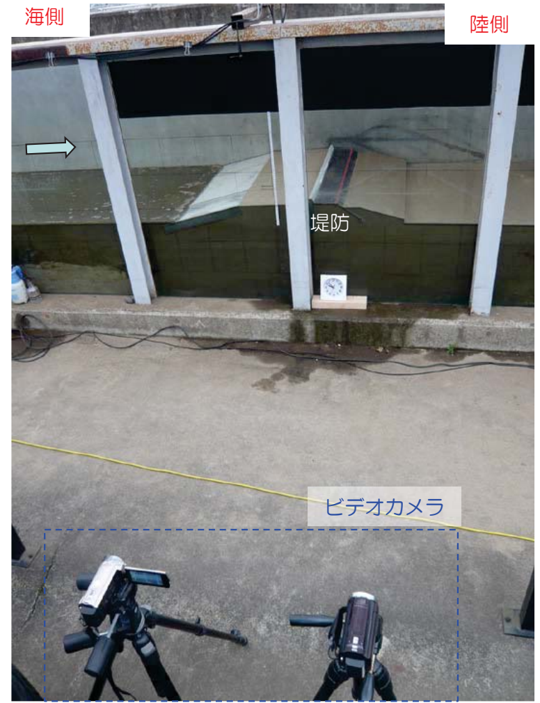
ビデオカメラの設置状況
