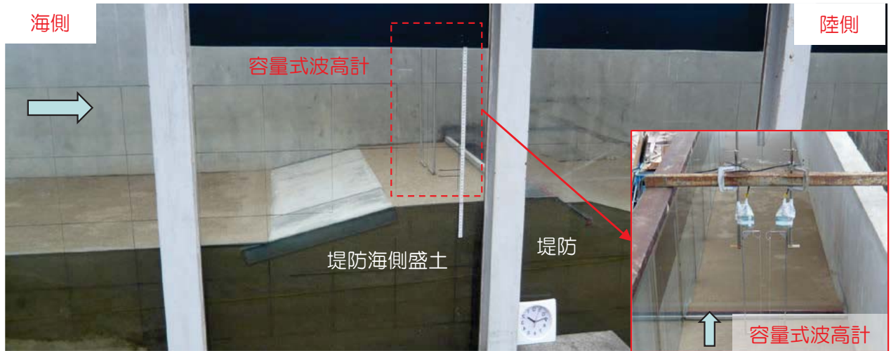
容量式波高計の設置状況
