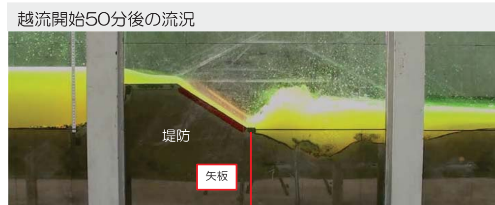
越流開始50分後における堤防及び背後地の洗掘状況
