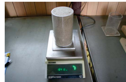
実験土砂の締固めの有無による単位体積重量の比較
