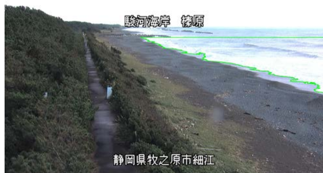
汀線ラインの判別状況（2019年10月4日の例）（引き波時）
