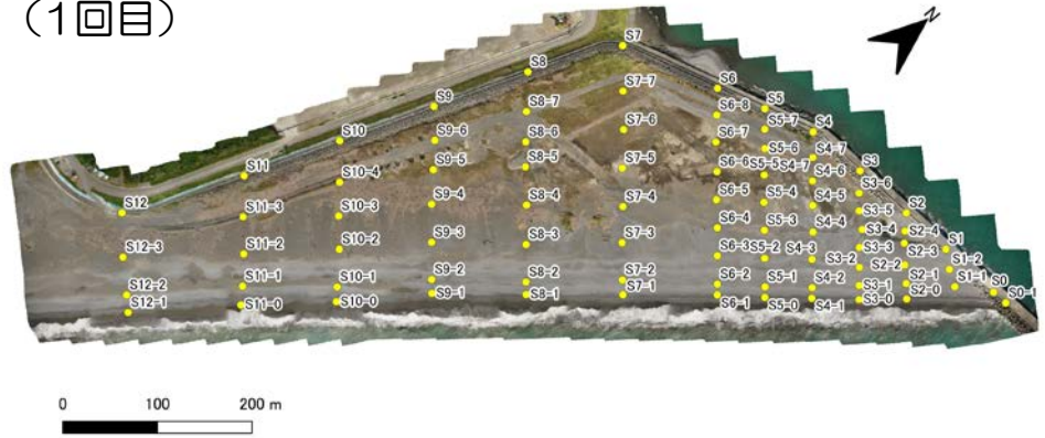
図 精度検証を実施したポイント (RTK-GPS測量)
