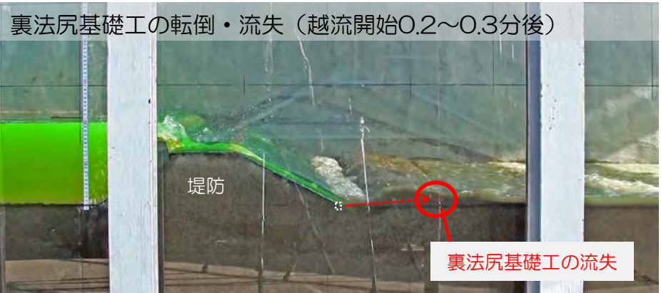
堤防(裏法戻基礎工)損壊時の流況及び洗掘状況
