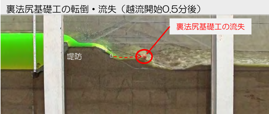
堤防（裏法尻基礎工）損壊時の流況及び洗掘状況
