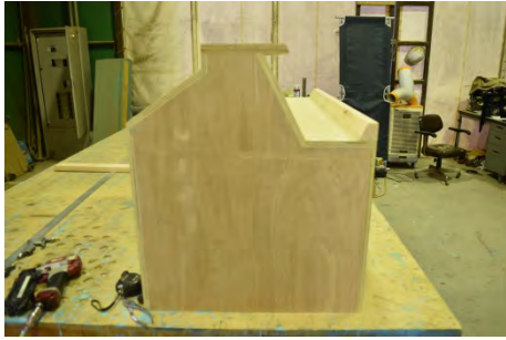
製作途中の木製堤防模型
