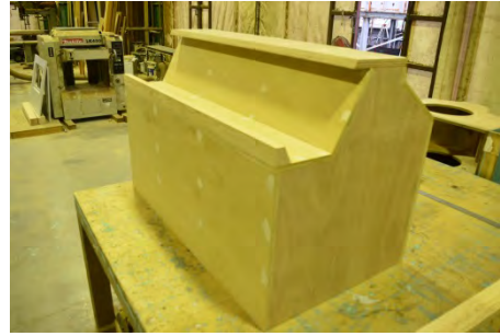
製作途中の木製堤防模型
