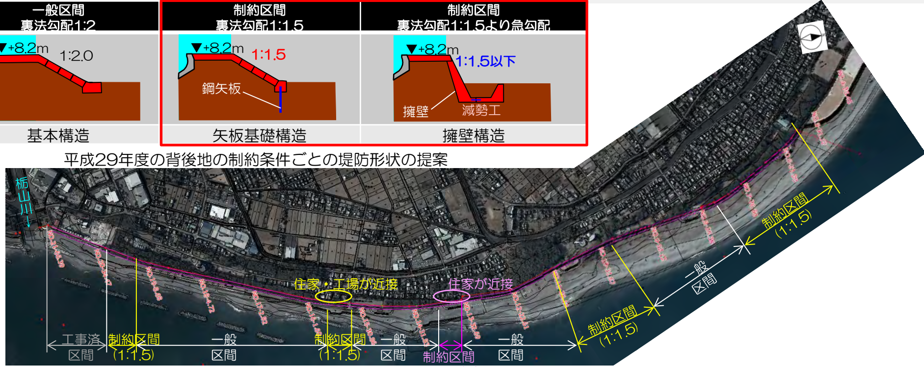
(1:1.5より急勾配) 栃山川より以東のT.P.+8.2m区間の背後地状況
