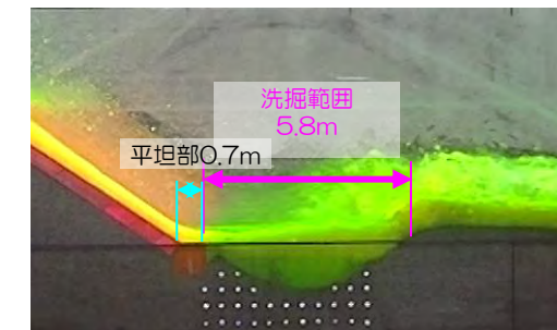
最大越流時間（1.4分後）における裏法尻基礎工の陸側地盤の洗掘状況
