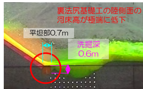
case2-2 法面勾配1:1.5：矢板基礎構造
