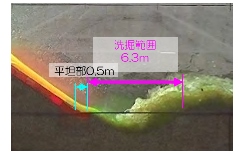
case2-3 法面勾配1:1.5：改良基礎構造
