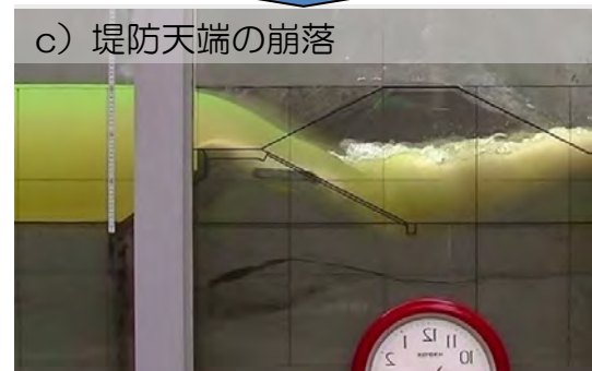
堤防破堤までの変状過程のイメージ
