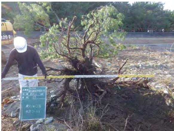
図-1 樹木の引き倒し試験
