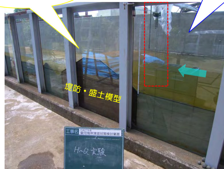
越流水深と水位上昇速度の確認実験状況
