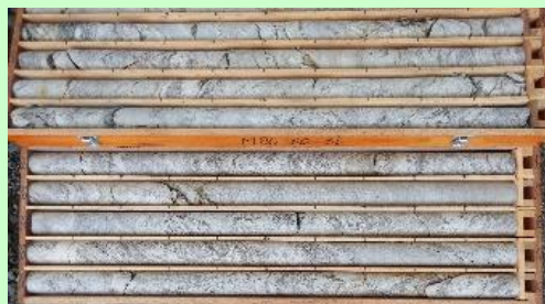
ボーリングコア (抜き取った棒状の試料)
