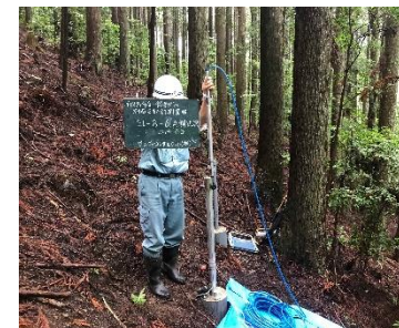
孔内傾斜計の観測状況: ボーリング孔に設置したアルミ製の管に、孔内傾斜計を挿入し、管の傾斜を深度50cmごとに計測します。
