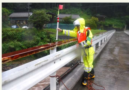
高水流量観測(浮子の投下)
