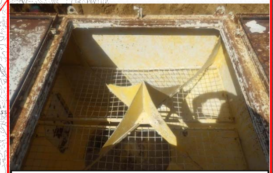
移動式土質改良機による粉じんの抑制
