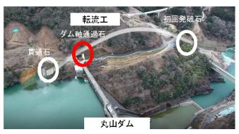
※転流工とは、ダム本体工事中に洪水を迂回させるトンネル水路です。
