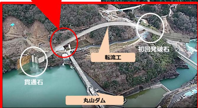
施工中の洪水処理イメージ
