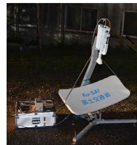
火災現場に設置されたKu-SAT
