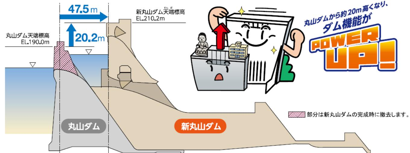
洪水時に新丸山ダムは、丸山ダムと比べて3.6倍の水を貯めることができます。7,200万m<sup>3</sup>の洪水調節容量のうち1,500万m<sup>3</sup>は、渴水時の河川環境の保全や用水の安定化等のために設けた不特定容量を予備放流により、洪水調節容量として有効活用します。
