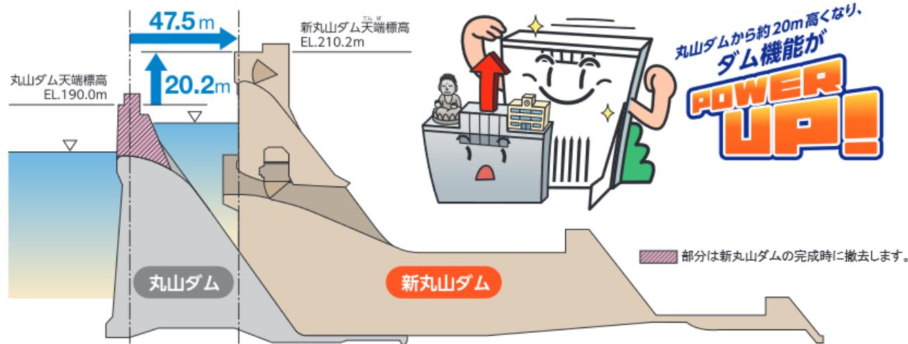
洪水時に新丸山ダムは、丸山ダムと比べて3.6倍の水を貯めることができます。7,200万 $m^3$ の洪水調節容量のうち1,500万 $m^3$ は、渇水時の河川環境の保全や用水の安定化等のために設けた不特定容量を予備放流により、洪水調節容量として有効活用します。
