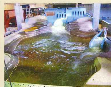
模型実験 工事中の水の流れを把握するための模型を使った実験
