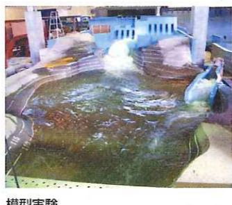
模型実験 工事中の水の流れを把握するために、模型を使った実験を行っています。
